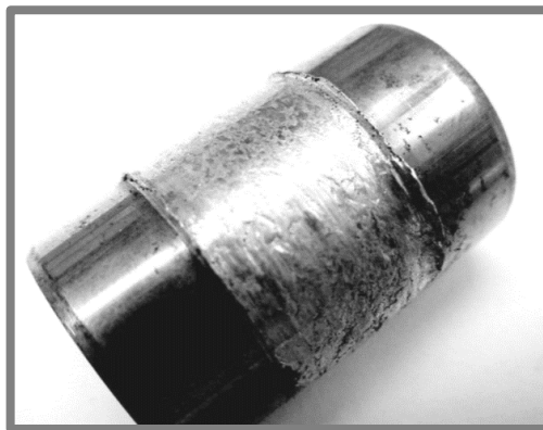
Obr. 2-17 Adhezivní opotřebení čepu [15]
