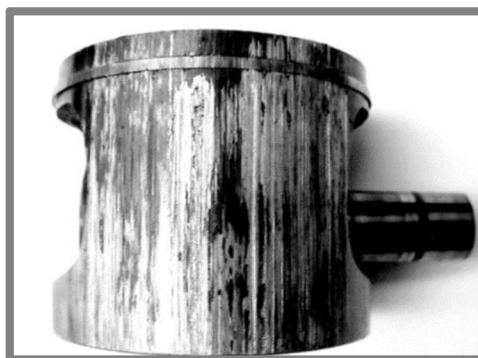
Obr. 2-19 Abrazivní opotřebení pístu spalovacího motoru [15]
