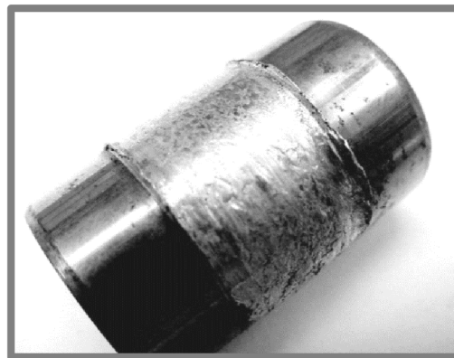
Obr. 2-17 Adhezivní opotřebení čepu [15]
