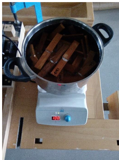
Obrázek č.12 Máčení a vaření těles před zatížením závažím (zdroj: autor práce)
