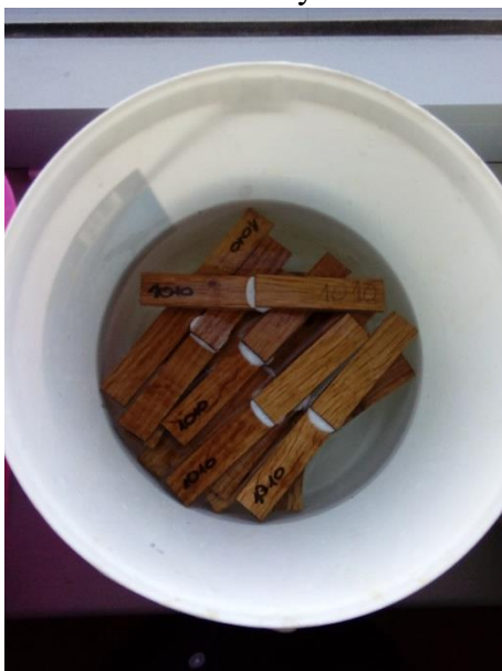
Obrázek č.12 Máčení a vaření těles před zatížením závažím (zdroj: autor práce)
