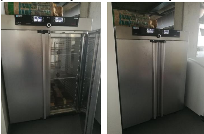
Obrázek č.9 Klimatizační komora Memmert HPP 750 (zdroj: autor práce)
