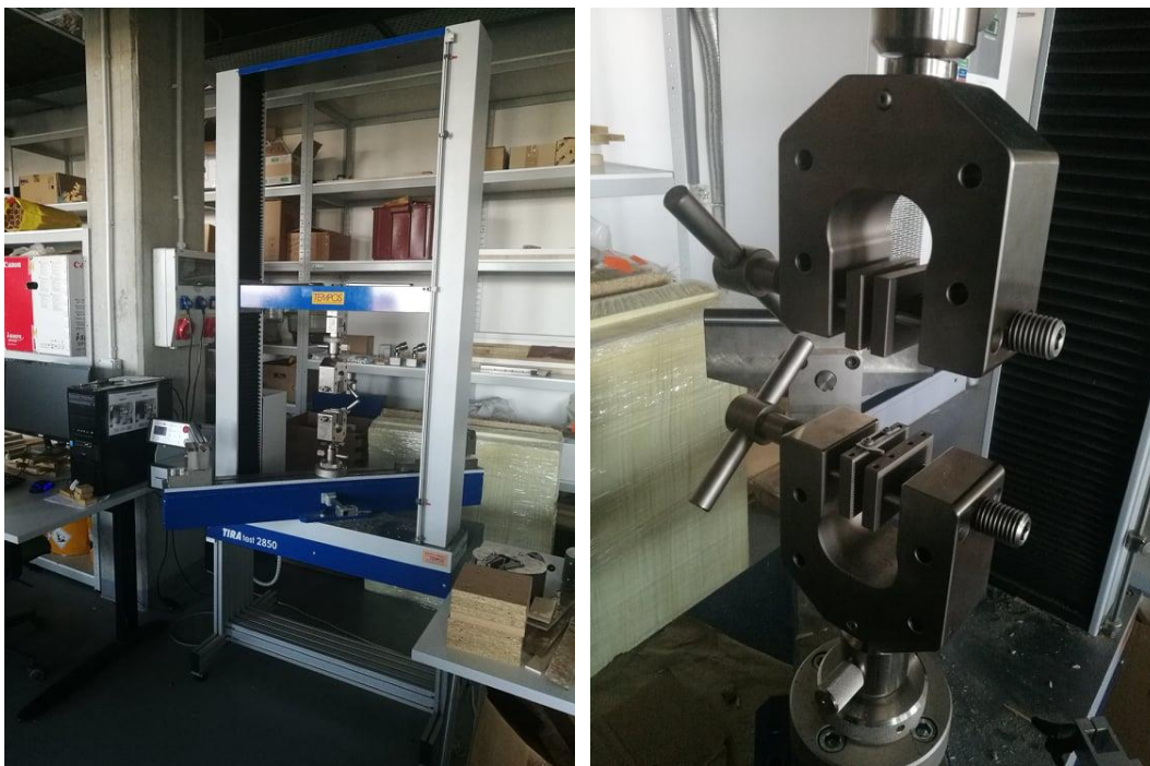
Obrázek č.14 Zkušební stroj a čelisti s nastavitelnými držáky (zdroj: autor práce)
