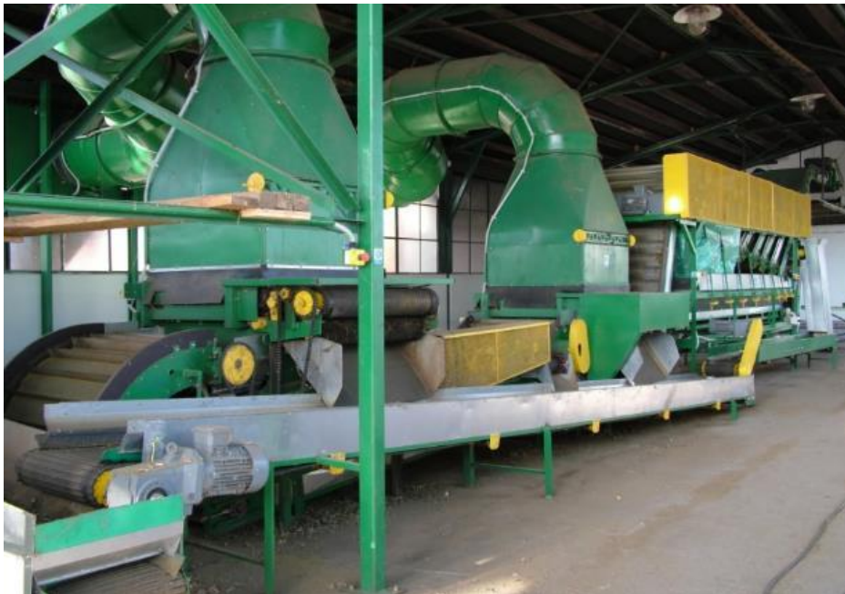
Obr. 14 Pneumatické odlučovače česací linky PT-15
