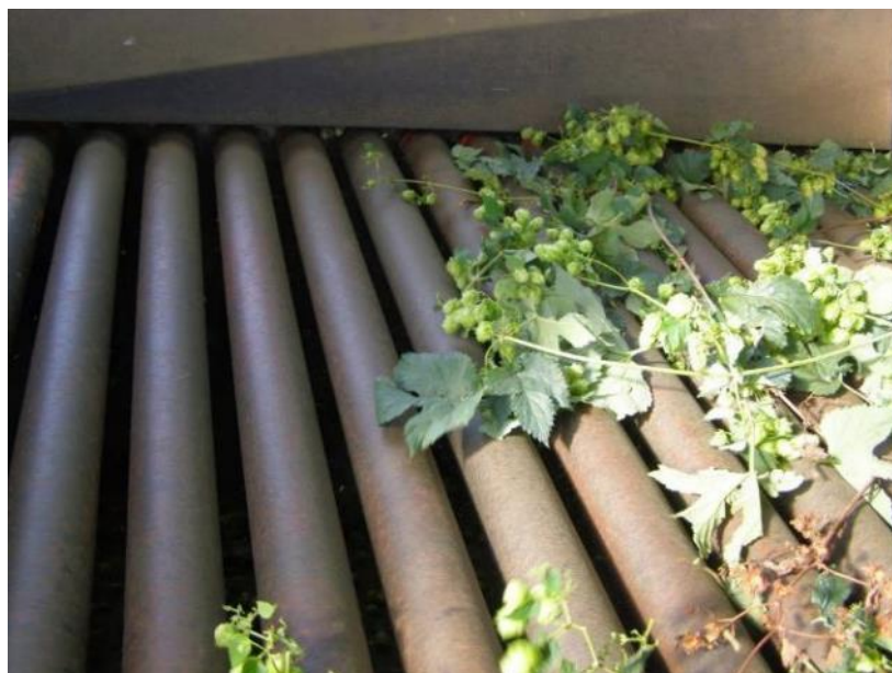
Obr. 9 Válečkové síto s hladkými válečky
