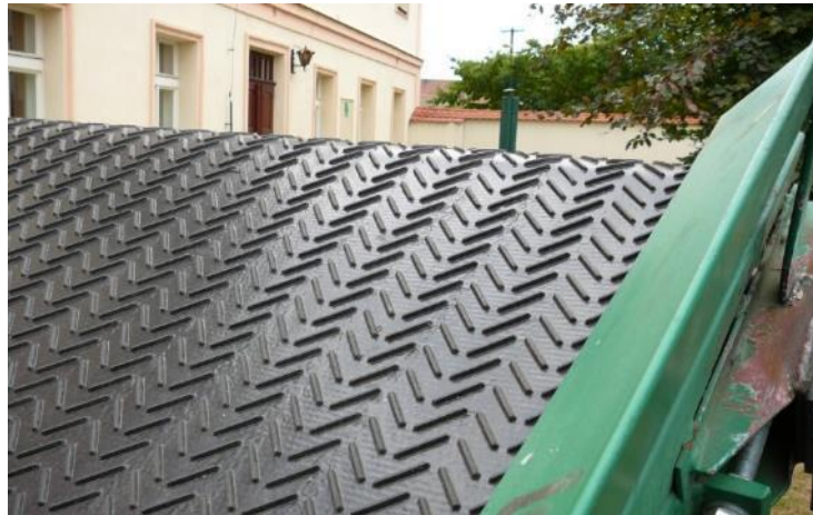
Obr. 17 Detail překulovače s výstupky klínovitého tvaru
