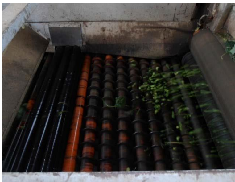
Obr. 10 Válečkové síto s mezikružím
