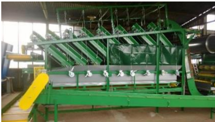
Obr. 16 Sekce překulovačů s pásy z PVC
