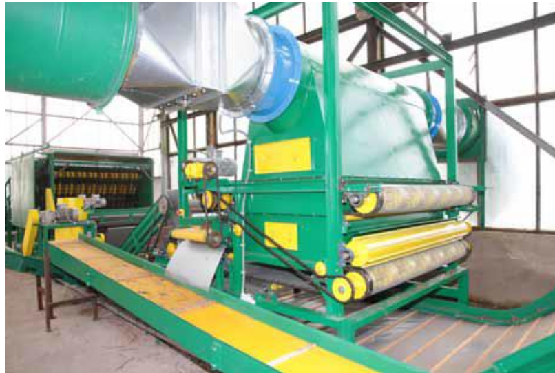
Obr. 15 Pneumatické odlučování česací linky PT-2000
