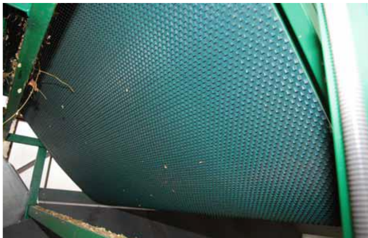
Obr. 18 Detail pilovitého pásu
