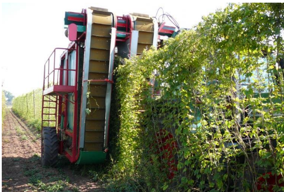
Obr. 5 Sklizeň chmele pomocí mobilního česacího stroje
