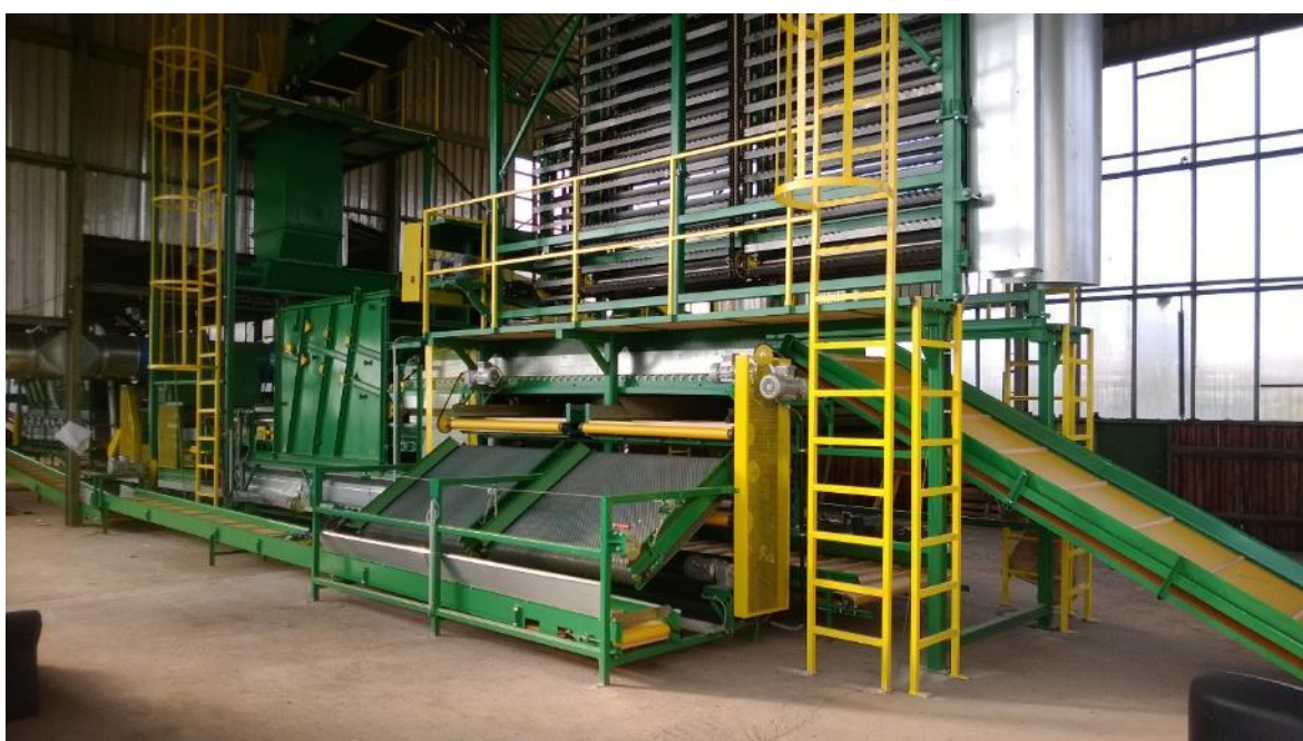
Obr. 21 Oddělená separace pod česací stěnou (překulovače na boku česací stěny)
