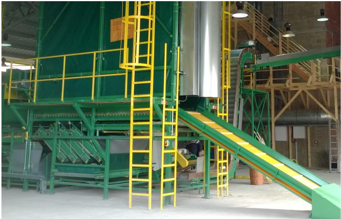
Obr. 22 Oddělená separace pod česací stěnou (překulovače umístěné podélně)
