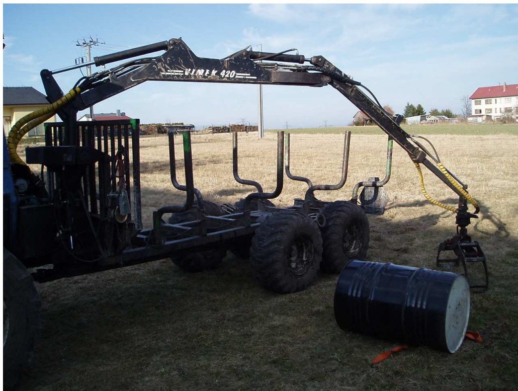
Obrázek 6.3: Očištěná hydraulická ruka, připravena k vizuální kontrole.
