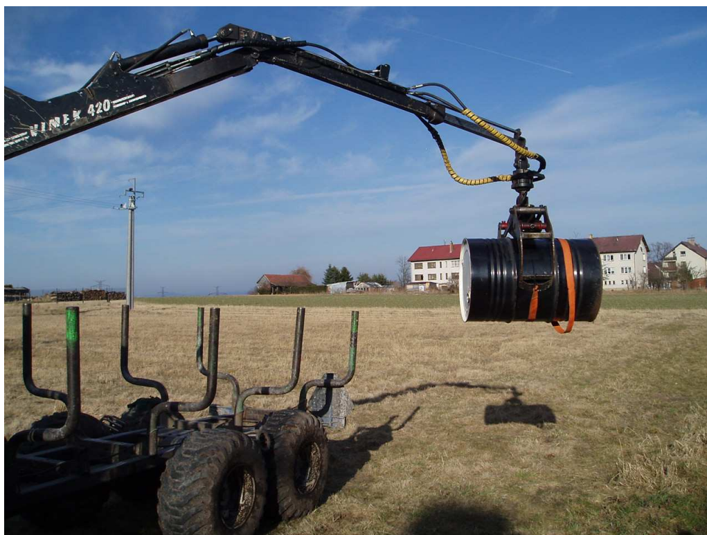
Obrázek 6.8: Měření rychlosti poklesu výložníku.
