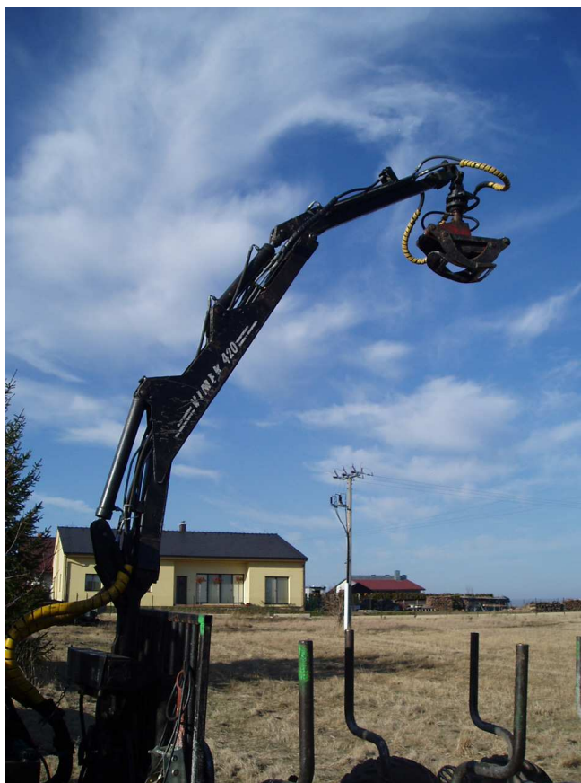
Obrázek 6.7: Maximální zdvih výložníku při měření rychlosti zvedání (bez zatížení).
