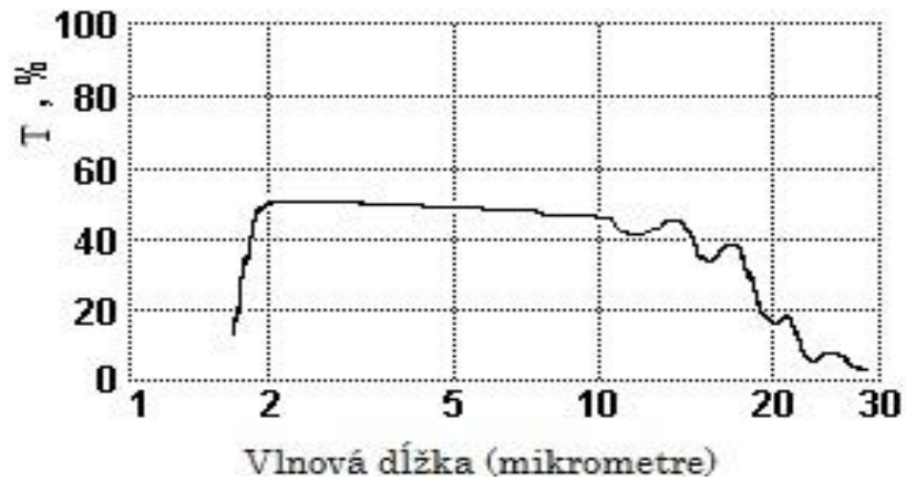
Obrázok 6: Spektrálna závislosť germánia (T- vnútorná priepustnosť) [21]
