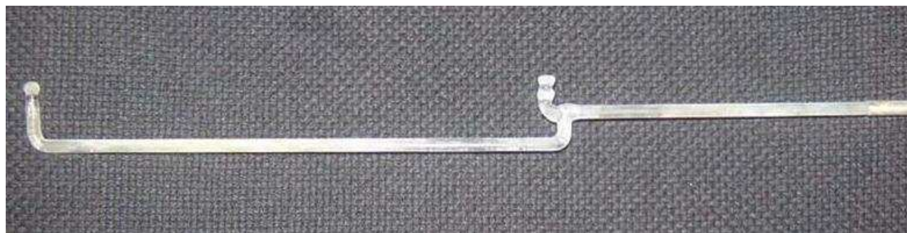
Obr. 21: Skleněný přípravek pro uchycení svazku skleněných vláken při depozici
