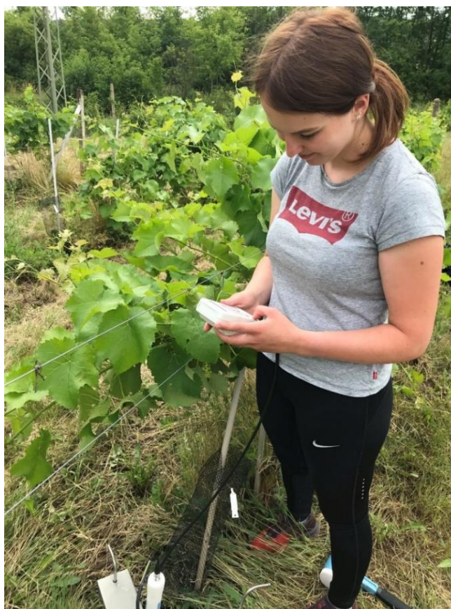
Obrázek 28: Měření objemové vlhkosti pomocí tyčové sondy, autor Kamila Hüttnerová.
