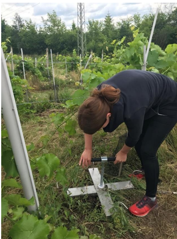
Obrázek 10: Připravená půdní sonda pro měření ambulantní vlhkostní sondou, autor: Kamila Hüttnerová.
