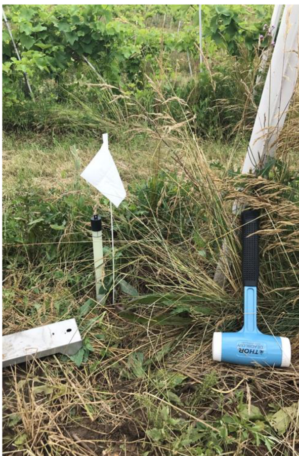
Obrázek 10: Připravená půdní sonda pro měření ambulantní vlhkostní sondou, autor: Kamila Hüttnerová.
