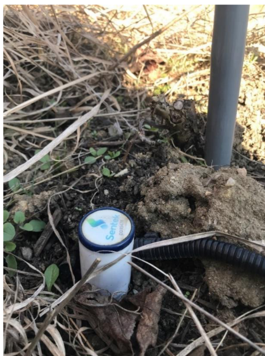
Obrázek 6: Profilová kontinuálně měřící sonda Sentek, autor Kamila Hüttnerová.
