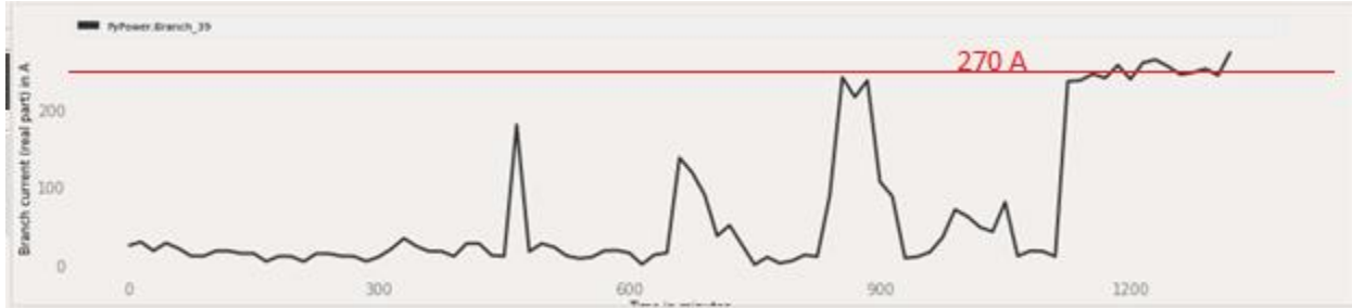
Obrázek 45, Překročení maximálního proudu 270 A na vedení, při nabíjení 32 elektromobilů, zdroj: vlastní
