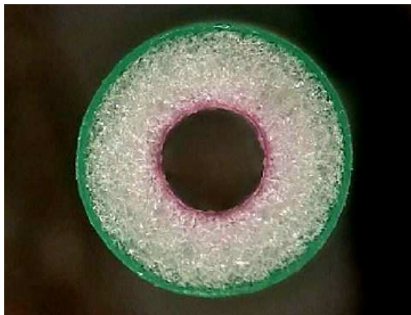
Obrázek 1.7: Řez izolace s napěněným PE [27]
