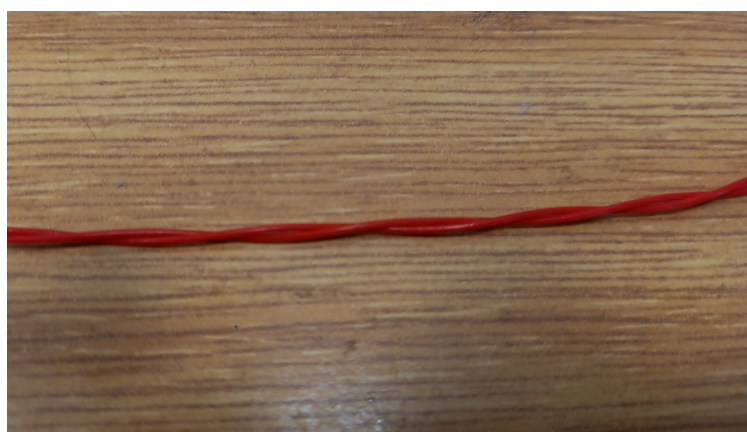
Obrázek 2.3: Detail zakrouceného vodiče
