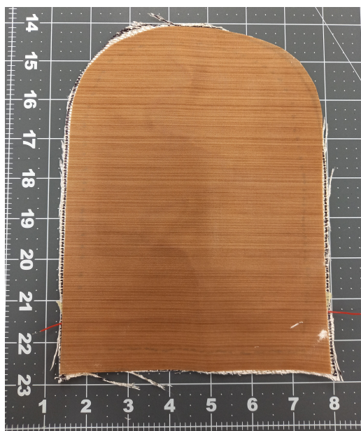
Obrázek 2.16: Textilie s vodiči VN a přilepenou teflonovou fólií
