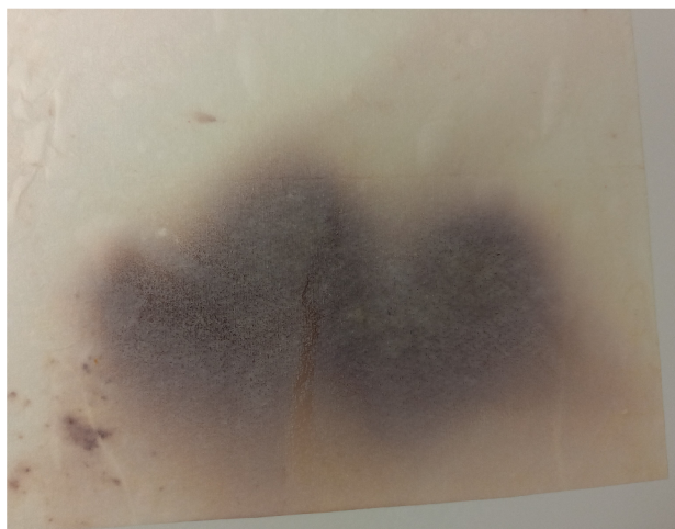
Obrázek 2.21: Filtrační papír napuštěný roztokem KI a škrobu po 120 sekundách působení ozonu
