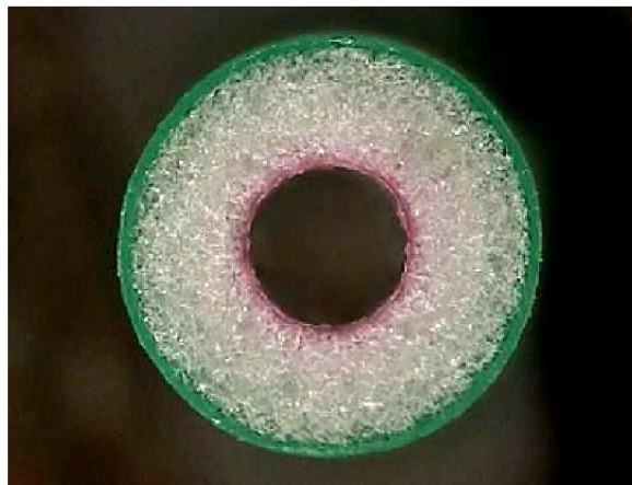
Obrázek 1.7: Řez izolace s napěněným PE [27]
