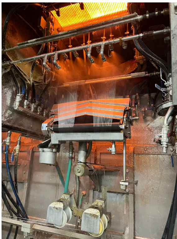
Obrázek 1.8: Tažení skelných vláken z roztavené skloviny
