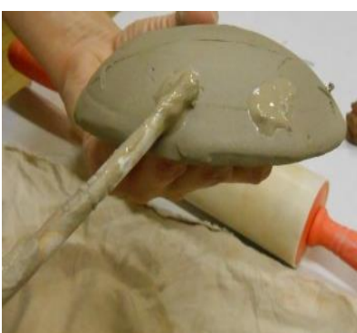
Obr. 12 Ozdoby a místa, kam je lepíme, zdrsňíme křížkem a přilepíme šlikrem.
