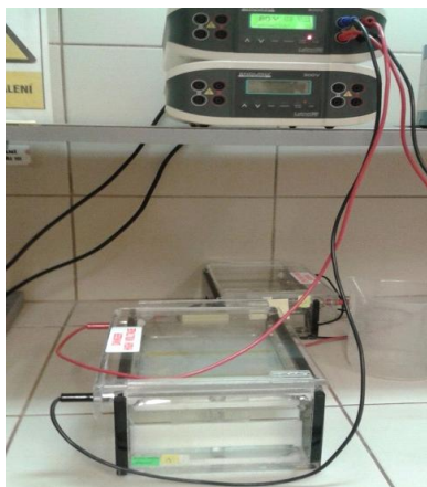
Obrázek 13: Zdroj elektrického napětí a zařízení pro elektroforézu (zpracováno autorkou)
