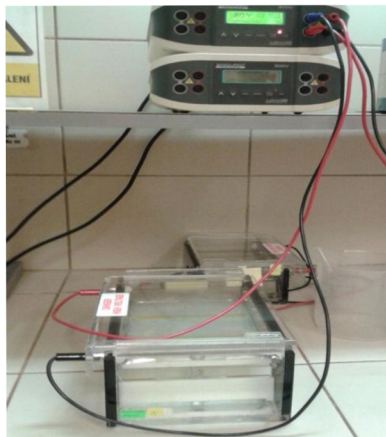
Obrázek 13: Zdroj elektrického napětí a zařízení pro elektroforézu (zpracováno autorkou)
