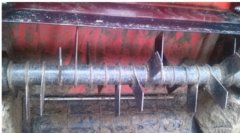
Obr. 5 Nožové ústrojí vertikutátoru (fotoarchív autora)
