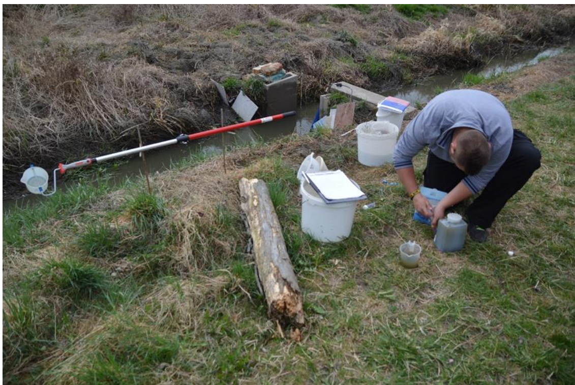
Obr. 4 Odběrové místo pod rybníkem Rovenský. Filtrace vzorku přes jednorázový nylonový filtr. (foto: Ján Regenda).
