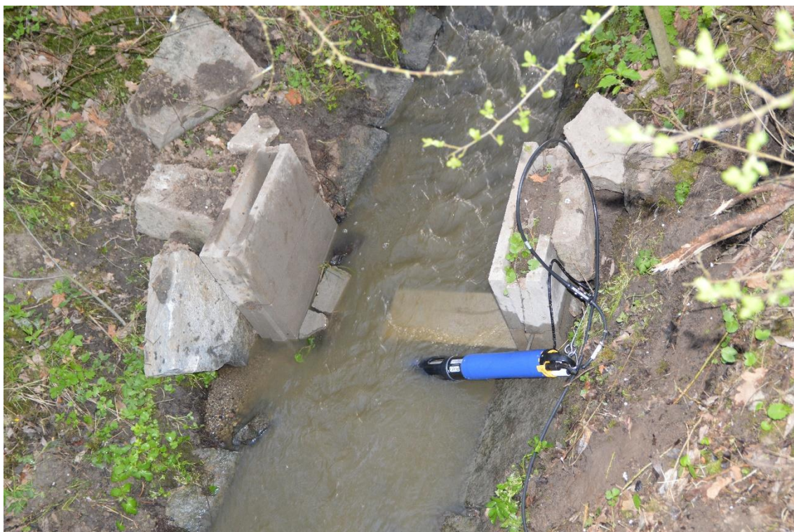
Obr. 5 Měření fyzikálně–chemických parametrů ve stoce pod rybníkem Luh multiparametrální sondou YSI EXO 2. (foto: Ján Regenda).
