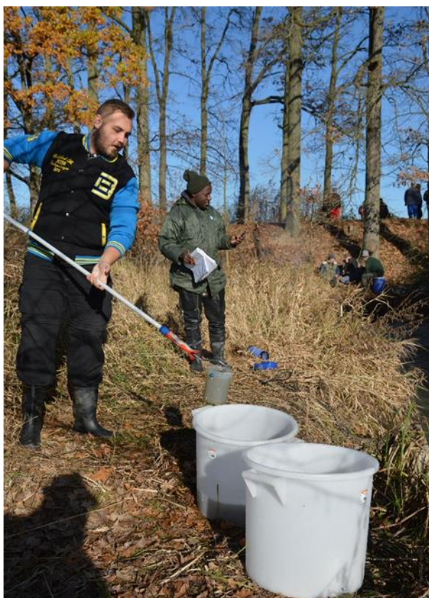
Obr. 3 Odběr vzorku vody teleskopickou tyčí a přelévání do připravených nádob. (foto: Ján Regenda).
