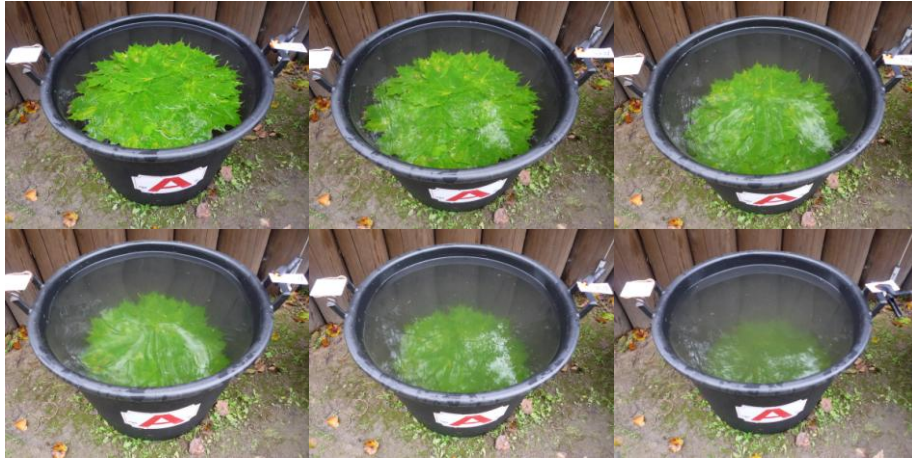
Obr. 5.8 Postupné ponořování jednoho z typů listů, první na hadině a pak klesání po 6 cm až do hloubky 30 cm.
