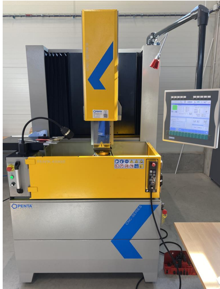
Obr. 3.3 Elektroerozivní hloubička PENTA 433GS CNC.
