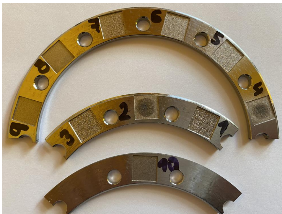
Obr. 3.9 Výsledné vyhloubené dutiny po hloubení grafitovou elektrodou.
