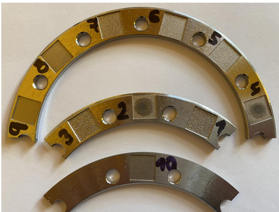
Obr. 3.9 Výsledné vyhloubené dutiny po hloubení grafitovou elektrodou.
