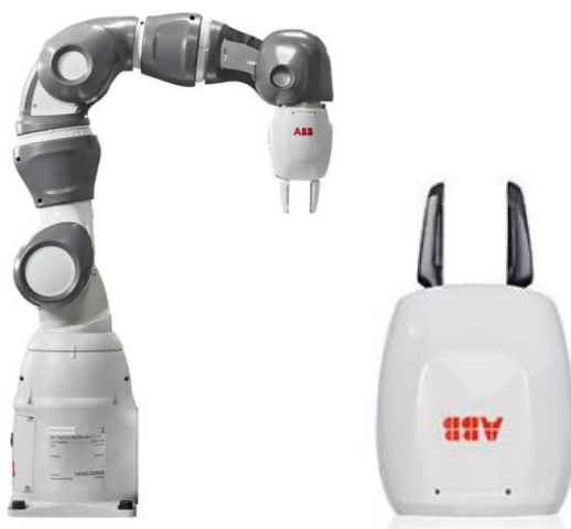
Obr. 28) a) Single-arm YuMi, b) Gripper se servomotorem [51] [52]
