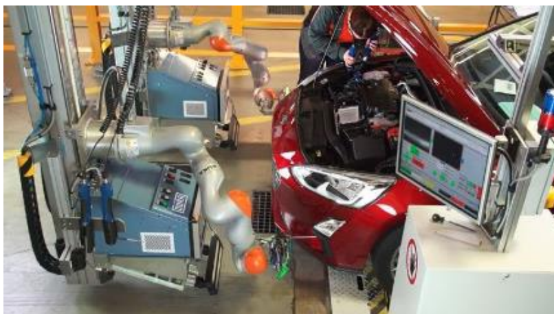
Obr. 13) Seřizování předních světlometů [37]
