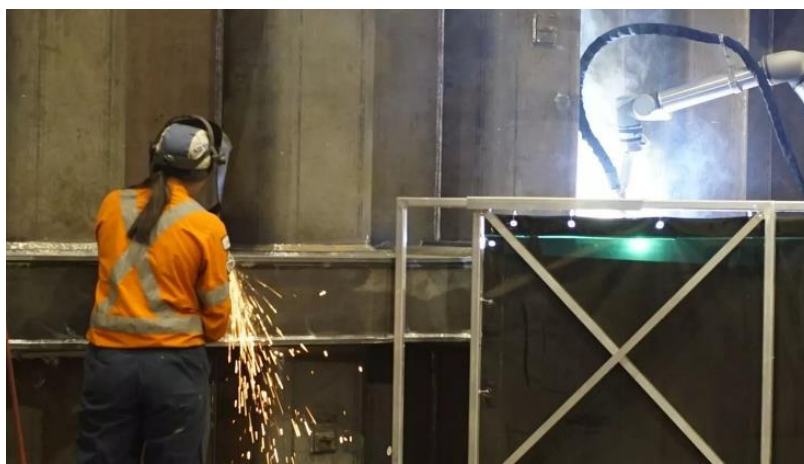
Obr. 15) Kolaborace při svařování žeber [41]
