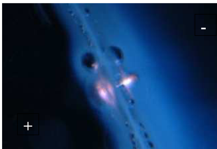
Obrázek č. 3: Fotografie diafragmového („bezelektrodového“) výboje
