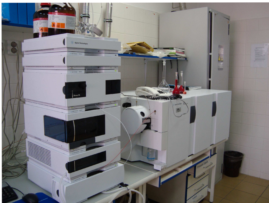
Obrázek č. 12: Kapalinový chromatograf Agilent 1200 Series s hmotnostním spektrometrem Agilent 6410 Triple Quad (LC-MS systém)
