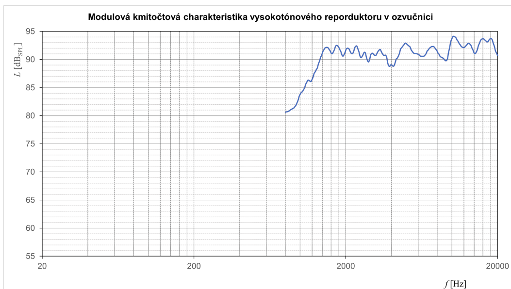
Obr. 4.4: Modulová kmitočtová charakteristika vysokotónového reproduktoru před korekcí
