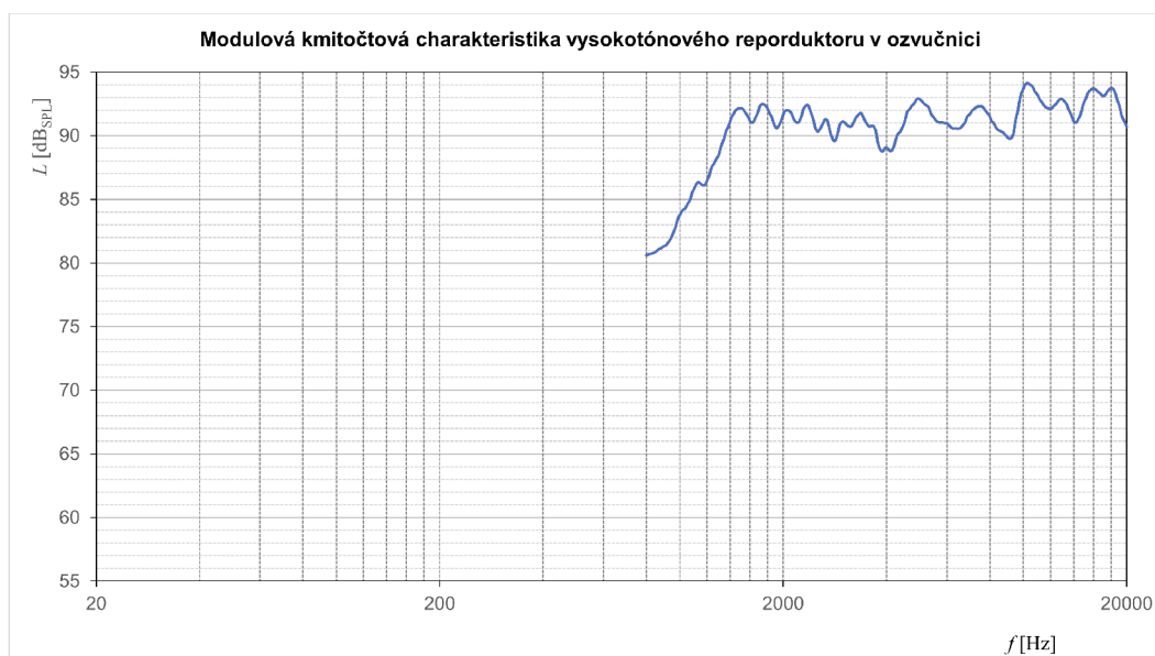
Obr. 4.4: Modulová kmitočtová charakteristika vysokotónového reproduktoru před korekcí
