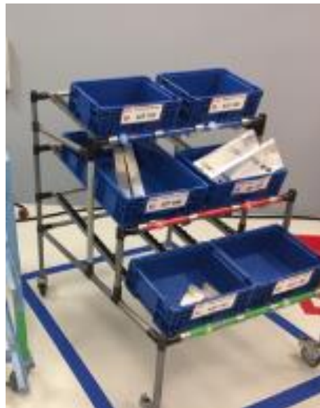
Obrázek 25: Vlastní konstrukce a montáž regálu pro tréninkové centrum [13]
