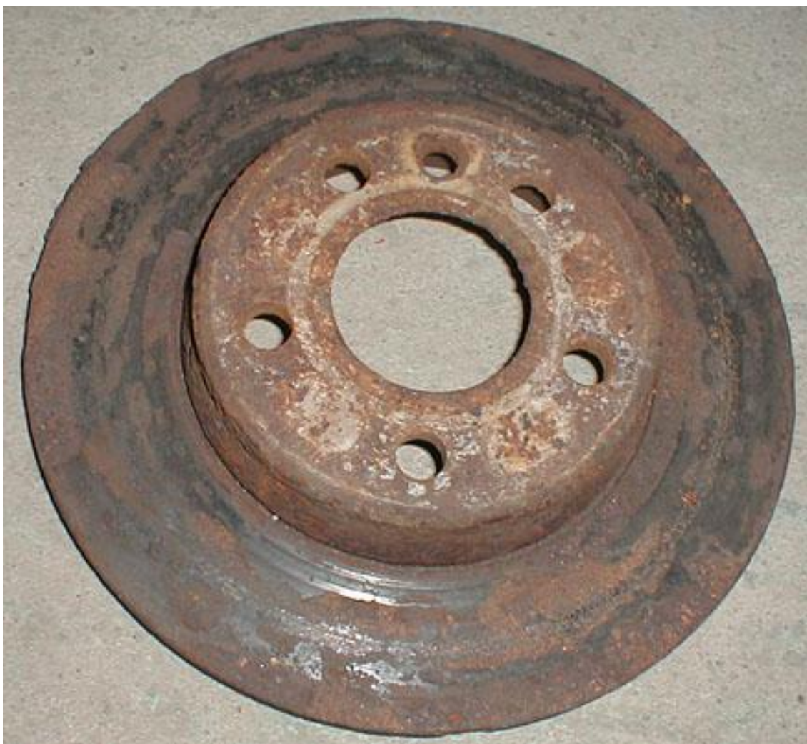
Obr. 20 Brzdový kotouč – koroze, Zdroj: vlastní
