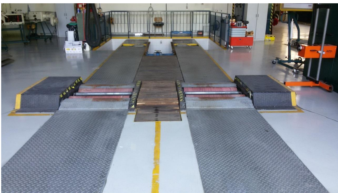
Obr. 12 Pomaloběžná válcová zkušebna brzd, Zdroj: vlastní
