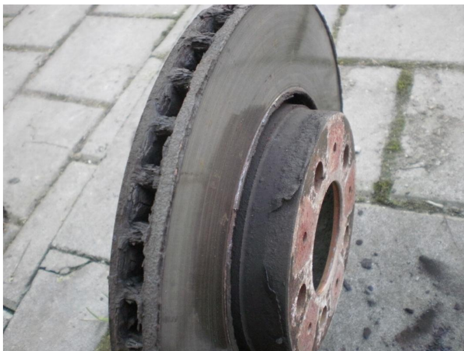
Obr. 18 Brzdový kotouč – opotřebovaný, Zdroj: vlastní
