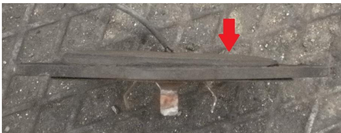
Obr. 19 Brzdová destička – opotřebovaná z jedné strany, Zdroj: vlastní
