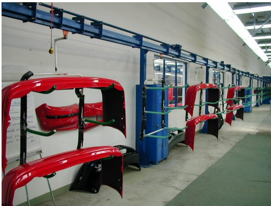
Obrázek 3 Podvěsný dopravník firmy TMT v lakovně automobilových dílů [13]
