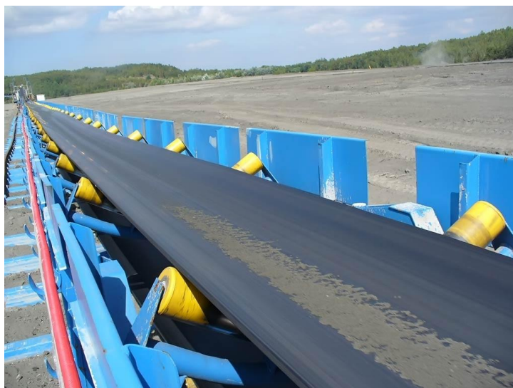
Obrázek 5 Stabilní pásový dopravník firmy Noen v povrchovém dole [5]
