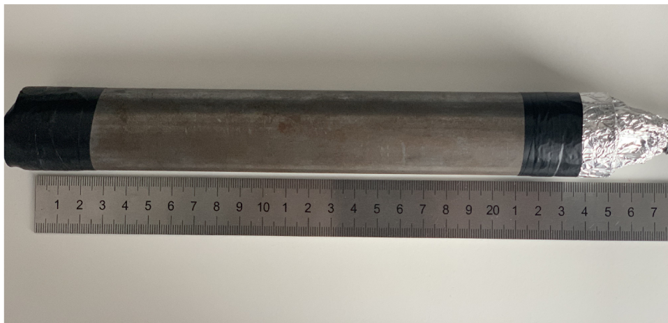
Obrázek 2.5: Snímek detektoru \gamma záření užitého během experimentů.
