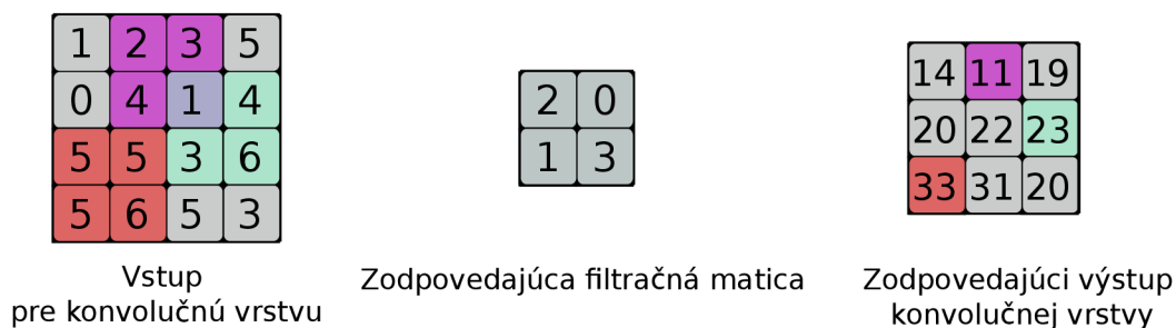
Obr. 3.10: Príklad znázornenia použitia konvolučnej vrstvy [15]
