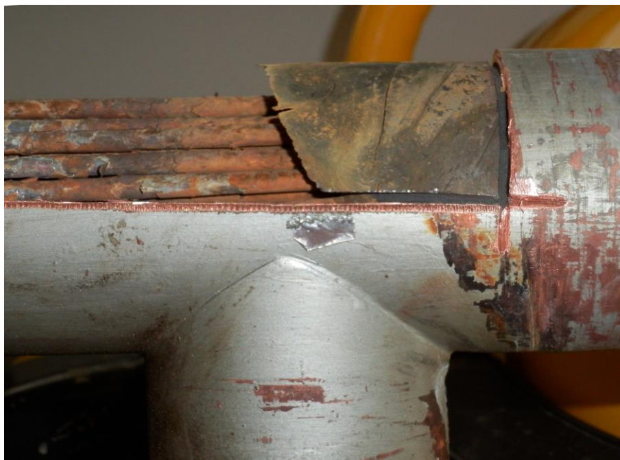
Obr. 16: Detail výměníku – prostor vyplněný tmelem
