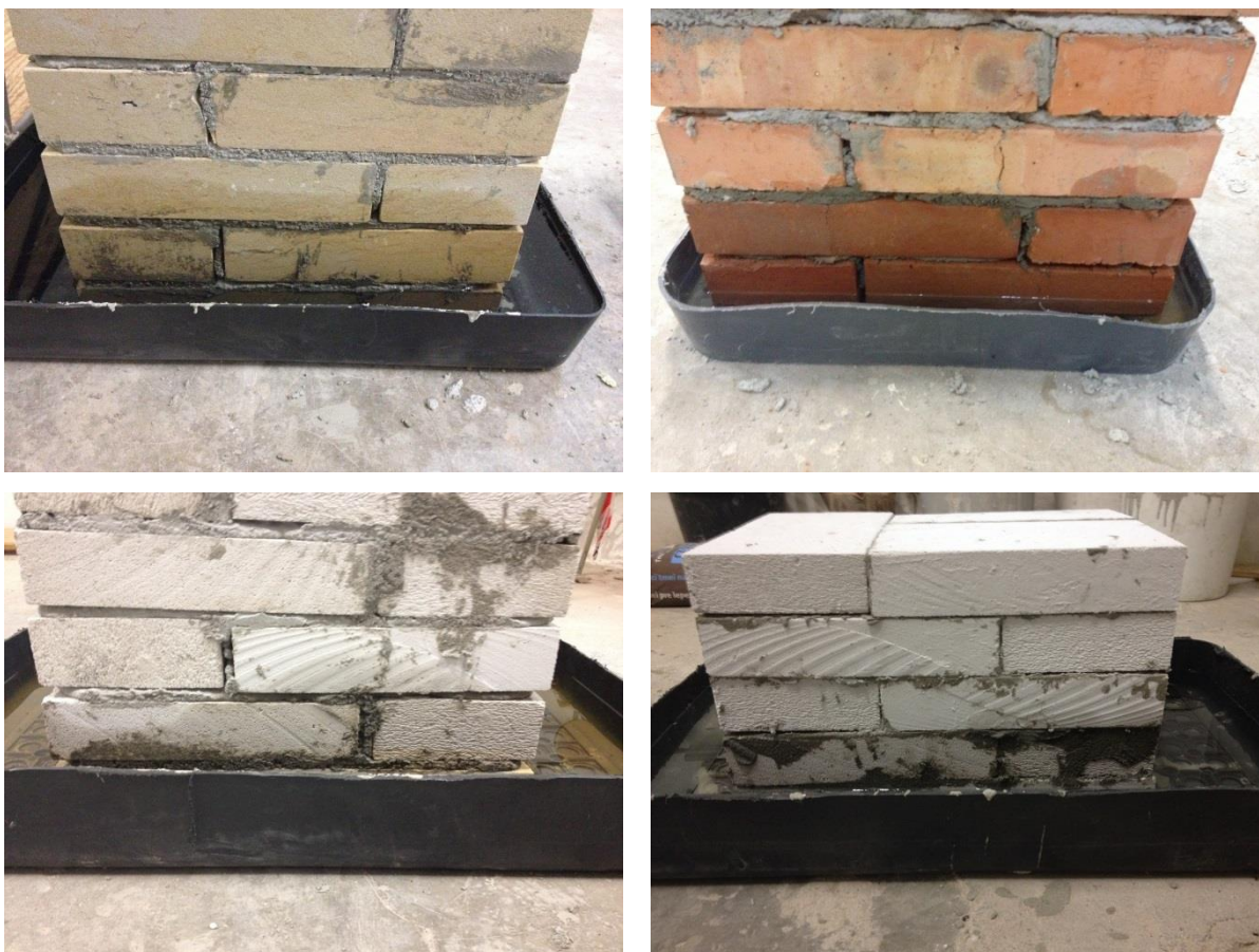
Obr. 26 – Postup vztlínající vlhkosti ve zkušebních pilířích po 24 hodinách (postupně: cihla pískovcová, cihla plná pálená, pórobeton klasické zdění, pórobeton přesné zdění)
