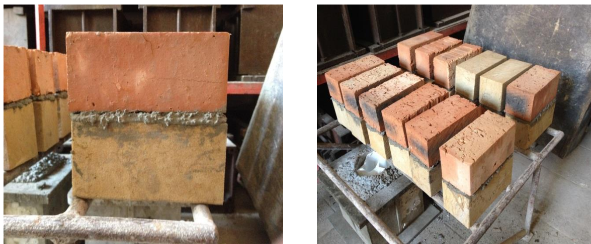
Obr. 22 – Zkušební vzorky smíšeného zdiva
