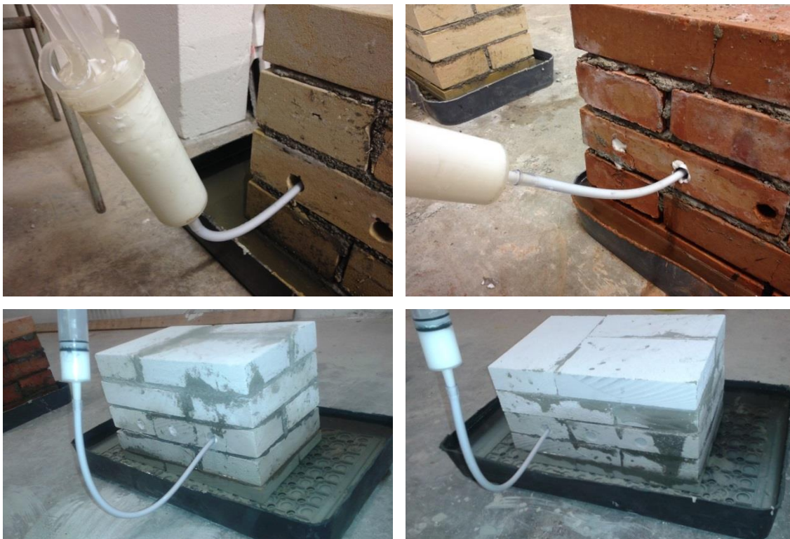
Obr. 28 – Injektáž zkušebních pilířů (postupně: cihla pískovcová, cihla plná pálená, pórobeton klasické zdění, pórobeton přesné zdění)
