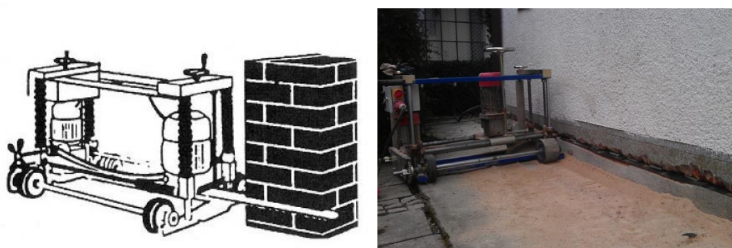
Obr. 7 – Schéma a foto řetězové pily [9], [17]
