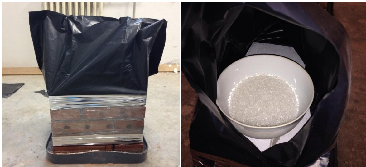
Obr. 29 – Zkušební pilíř cihly plné pálené opatřený plastovým „zvonem“ a umístění silikagelu v plastovém „zvonu“
