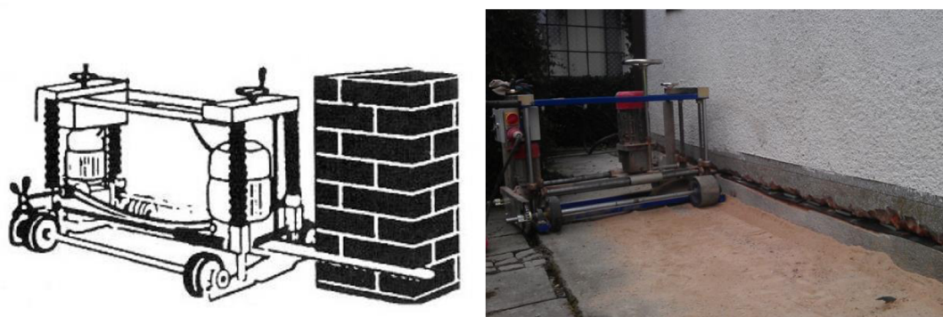
Obr. 7 – Schéma a foto řetězové pily [9], [17]
