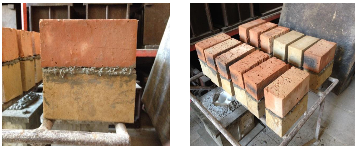
Obr. 22 – Zkušební vzorky smíšeného zdiva
