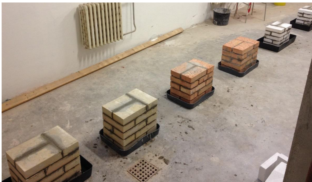
Obr. 19 – Vyzděné zkušební pilíře (postupně zleva: 2x cihla pískovcová, 2x cihla plná pálená, 2x pórobeton klasické zdění)
