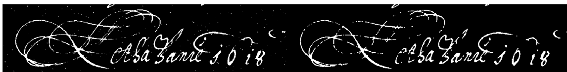
Obrázek 1.7: Ukázka obrázku před a po aplikaci morfologické operace open – odstranění šumu v popředí.
