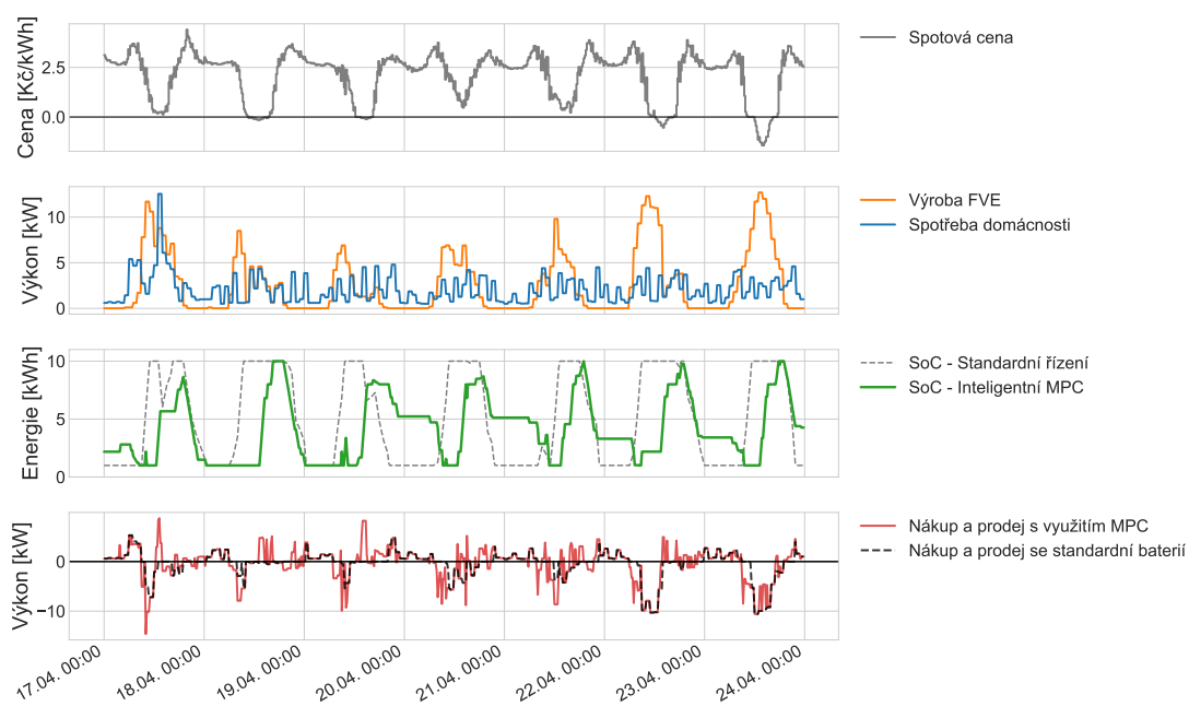
Graf 4.2: Porovnání zásahů MPC a standardního řízení baterie v dubnovém týdnu.
