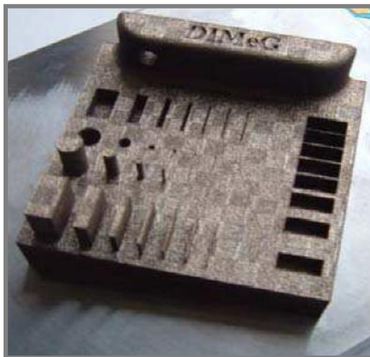
Obr. 2-17 Zkušební vzorek pro testování rozměrové přesnosti [23]
