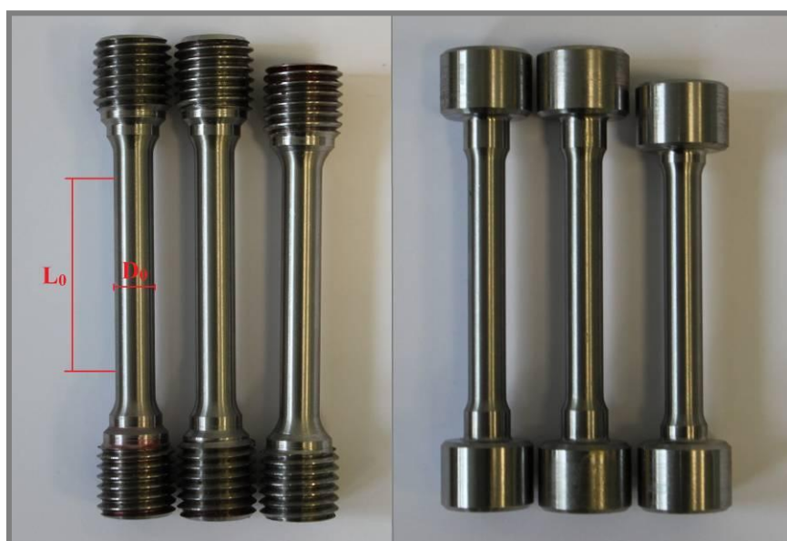
Obr. 5-9 Vzorky pro tahovou zkoušku, vyrobené na M2 (vlevo) a PXL (vpravo)
