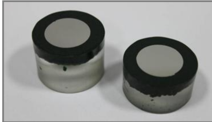
Obr. 5-10 Výbrusy obou typů materiálů pro zkoušku tvrdosti
