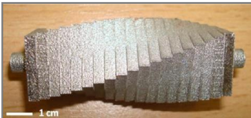
Obr. 2-9 Součást pro testování drsnosti nakloněných ploch [15]
