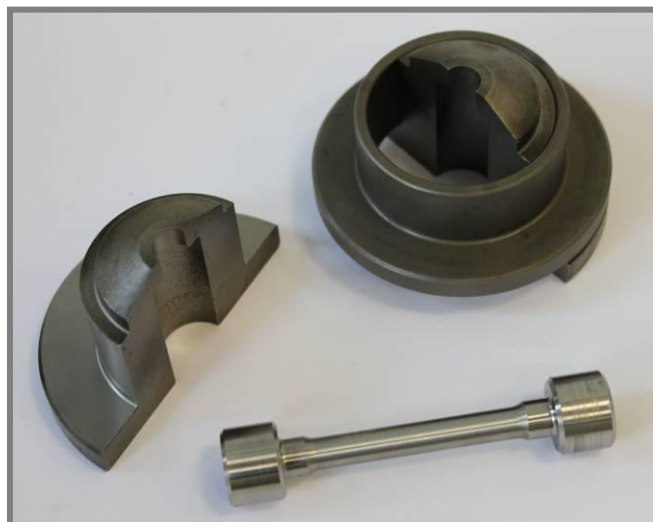
Obr. 5-8 Kroužkové upnutí válcové hlavy vzorku PXL
