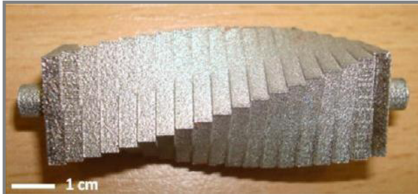
Obr. 2-9 Součást pro testování drsnosti nakloněných ploch [15]
