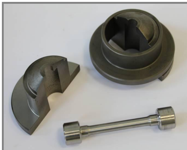
Obr. 5-8 Kroužkové upnutí válcové hlavy vzorku PXL
