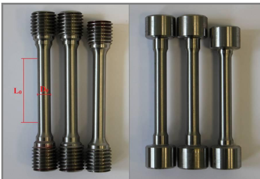
Obr. 5-9 Vzorky pro tahovou zkoušku, vyrobené na M2 (vlevo) a PXL (vpravo)
