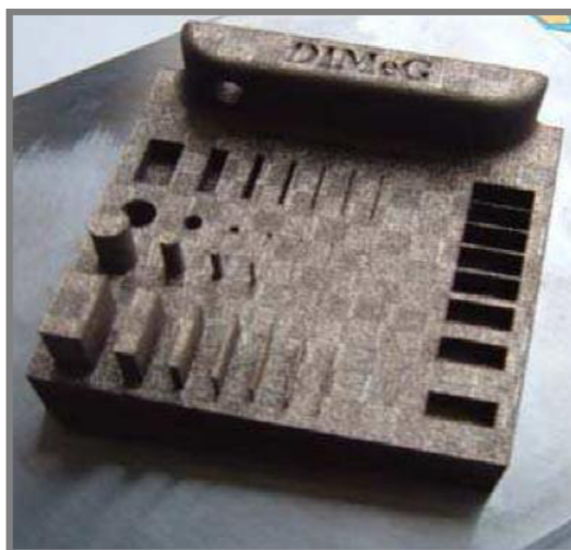
Obr. 2-17 Zkušební vzorek pro testování rozměrové přesnosti [23]
