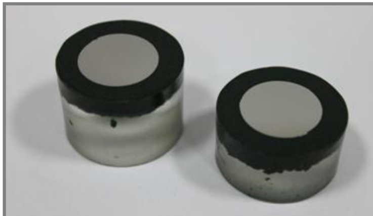
Obr. 5-10 Výbrusy obou typů materiálů pro zkoušku tvrdosti
