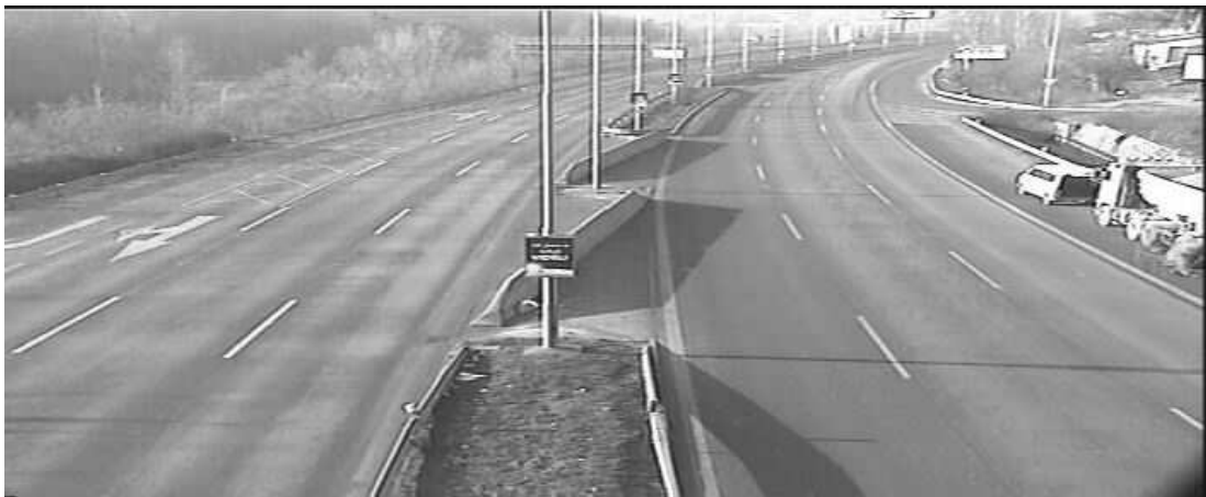
Obrázek 5: Model získaný průměrováním z 25 snímků
