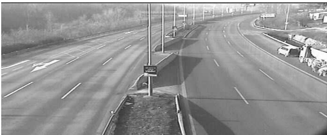
Obrázek 8: Model získaný klouzavým průměrem ze 100 snímků
