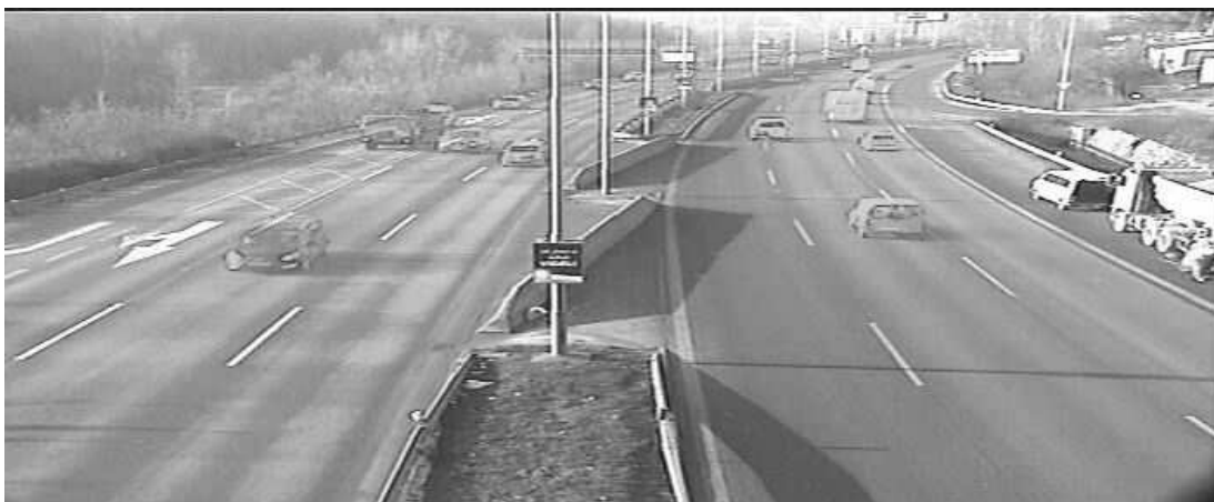
Obrázek 7: Model získaný klouzavým průměrem z 25 snímků
