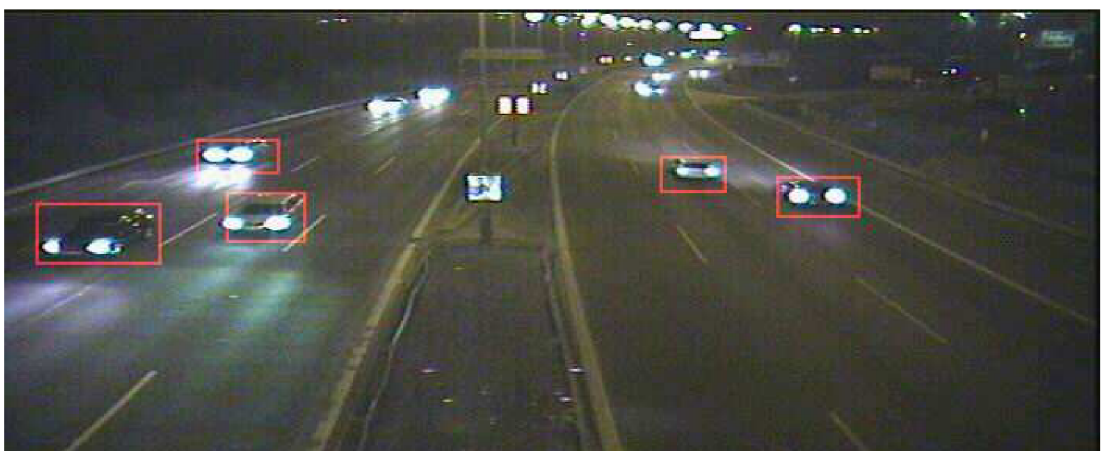
Obrázek 46: Označené objekty – ekvalizace histogramu
