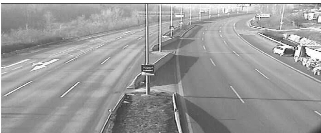
Obrázek 10: Model získaný mediánem ze 100 snímků
