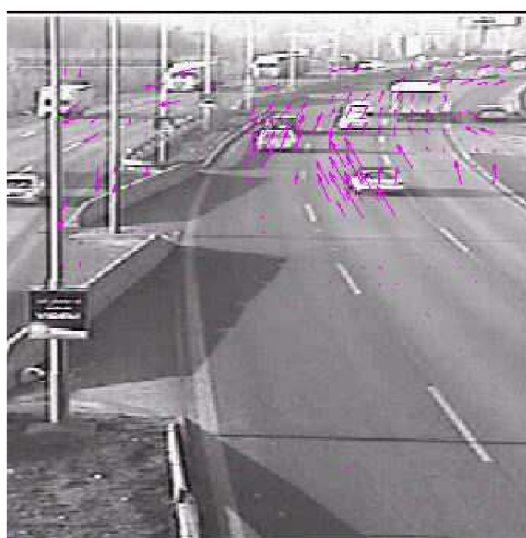
Obrázek 35: Výsledek – optický tok
