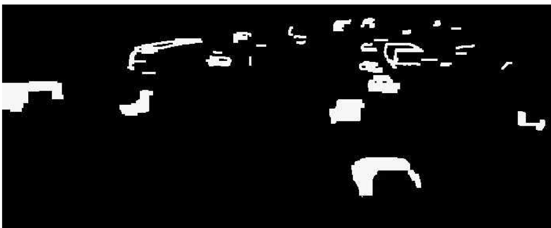
Obrázek 38: Dilatace a následná eroze nalezených objektů
