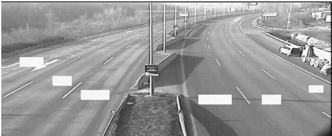
Obrázek 48: Oblasti pro počítání vozidel v jízdních pruzích
