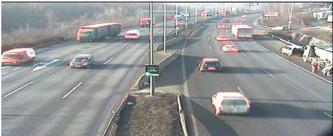
Obrázek 22: Výsledek – objekty označené detekcí hran v akt. bar. snímku
