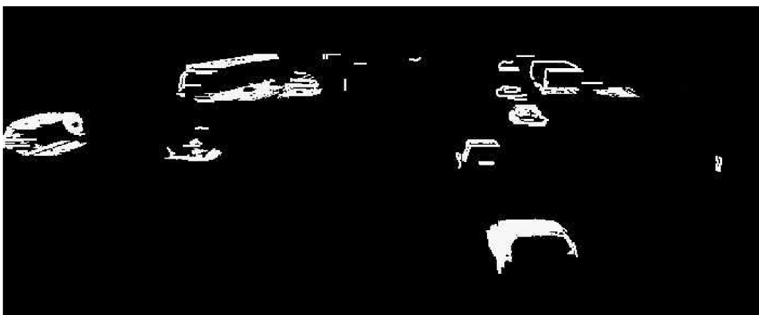
Obrázek 27: Obrys nalezených objektů v jízdnicích
