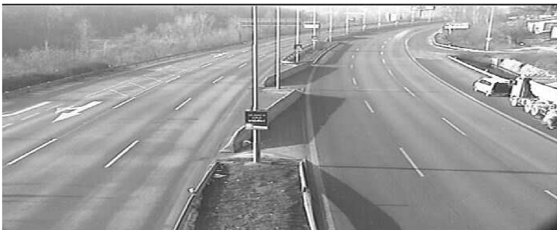
Obrázek 9: Model získaný mediánem z 25 snímků
