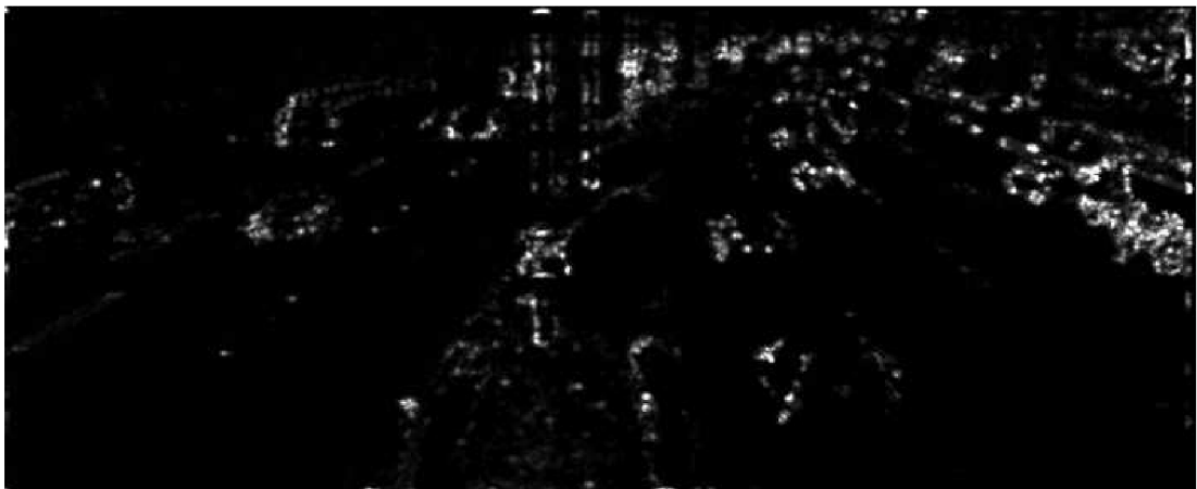
Obrázek 29: Výstup z Harrisova detektoru významných bodů
