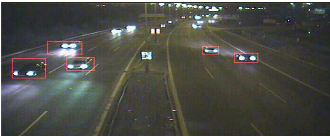
Obrázek 44: Označené objekty v aktuálním nočním snímku
