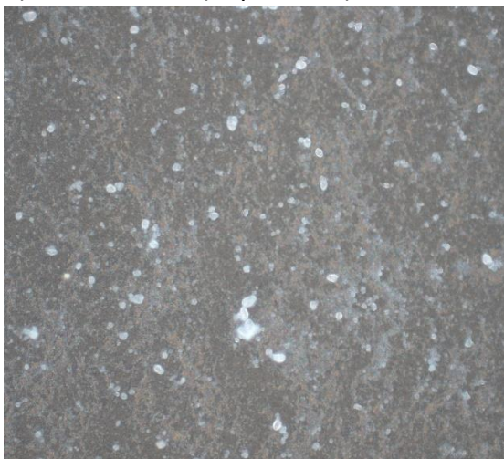
Obrázek 28: Snímky z optického mikroskopu vrstev připravených spin coatingem a odpařováním z různých suspenzí JF YAG.
