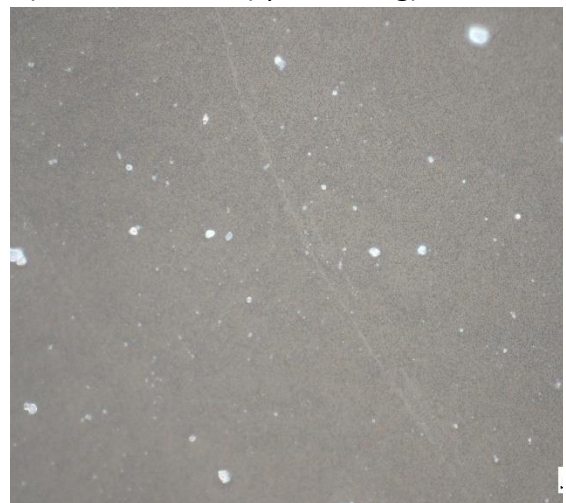
Obrázek 28: Snímky z optického mikroskopu vrstev připravených spin coatingem a odpařováním z různých suspenzí JF YAG.
