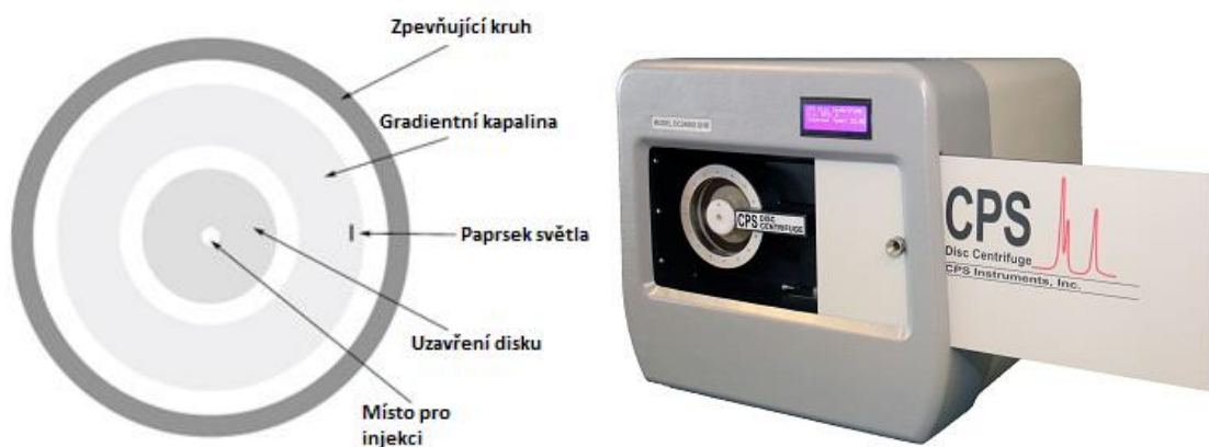
Obrázek 13: Ilustrace a princip CPS diskové centrifugy. Přeloženo a převzato z [51].
