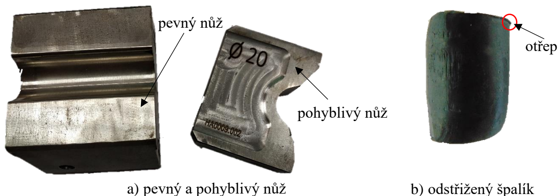
Obr. 7 Pevný, pohyblivý nůž a odstřížený špalík
