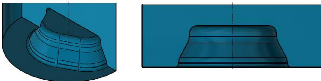
Obr. 83 Úprava předkovacího razníku-„zlom“
