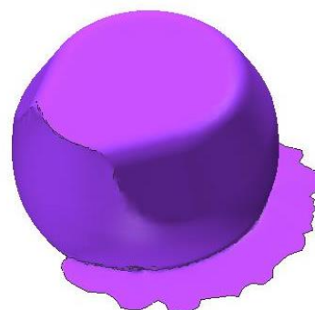
Obr. 53 Nereálný tok otřepu
