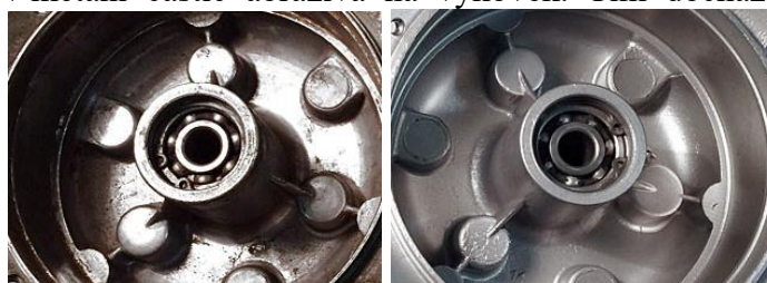
a) neotryskaný povrch b) otryskaný povrch
