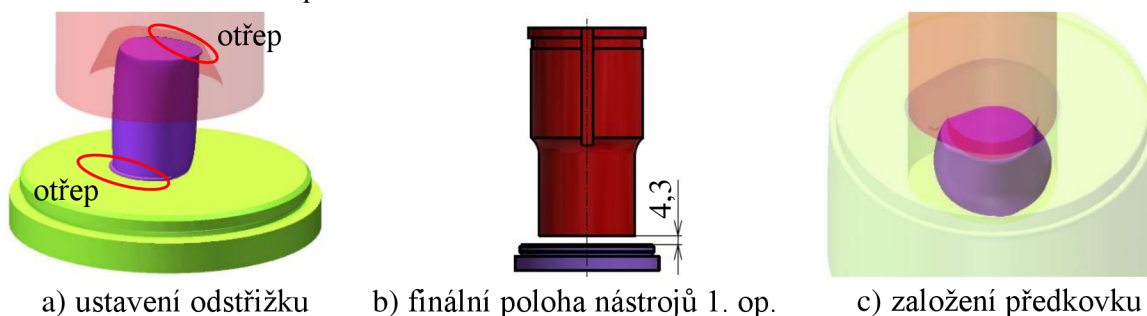
Obr. 50 Ustavení polotovaru a poloha nástrojů
