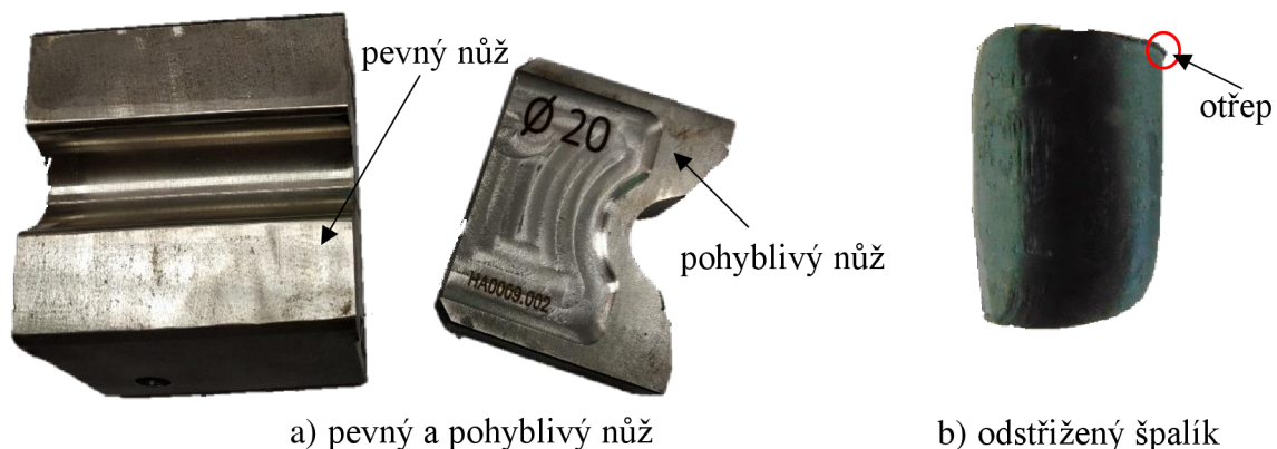
Obr. 7 Pevný, pohyblivý nůž a odstřížený špalík
