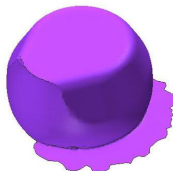
Obr. 53 Nereálný tok otřepu
