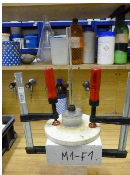
Obrázek 29: Provádění vodotěsnosti povrchové úpravy na impregnovaném vzorku
