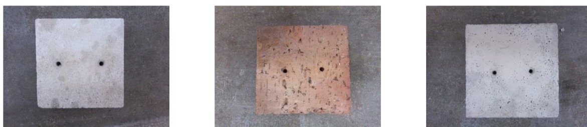
Obrázek 30: Ukázka těles připravených k infuznímu napouštění (postupně pórobeton, cihla plná pálená, zdicí malta)
