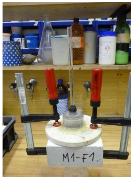
Obrázek 29: Provádění vodotěsnosti povrchové úpravy na impregnovaném vzorku
