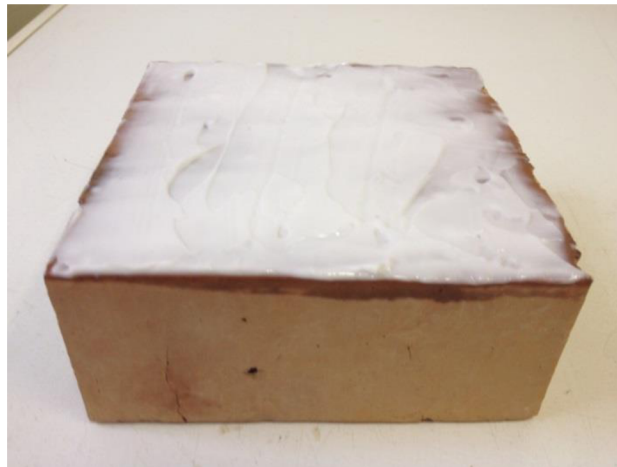
Obrázek 28: Ukázka impregnace zkušebního vzorku
