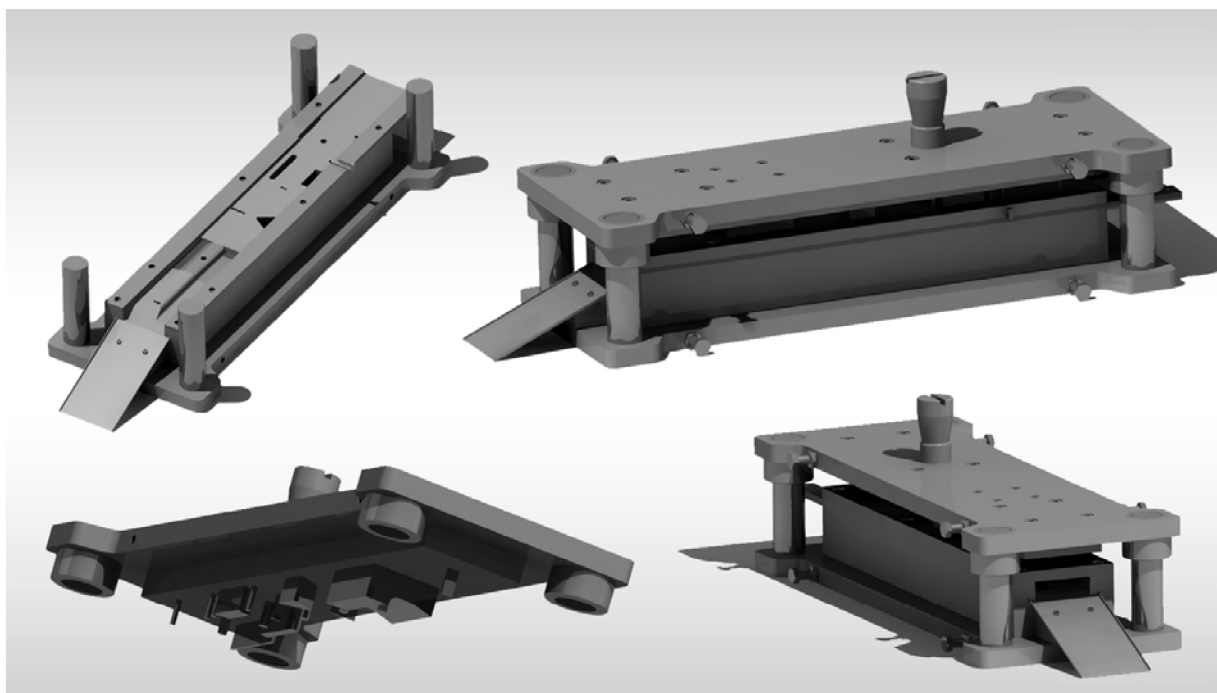
Obr. 50 Vizualizace sruženého postupového nástroje
