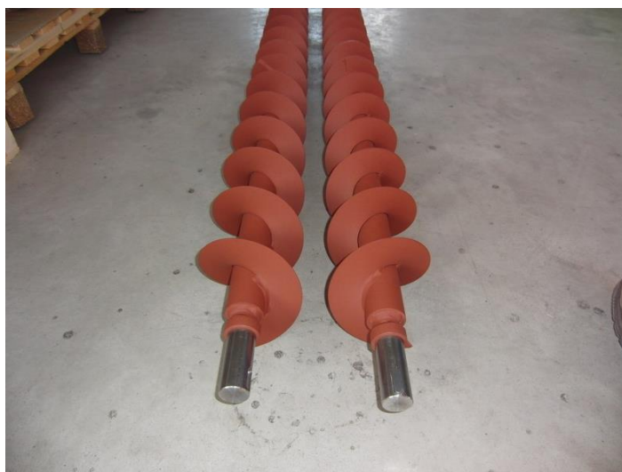
Obr. 4 Šnekovice levotočivá (vlevo), pravotočivá (vpravo) [25]
