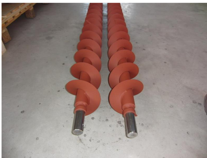
Obr. 4 Šnekovice levotočivá (vlevo), pravotočivá (vpravo) [25]
