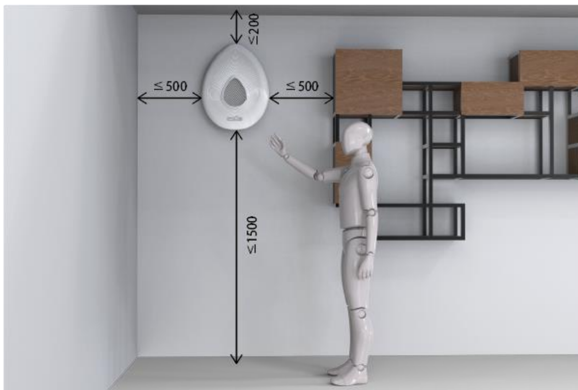
Obr. 6-20 Schéma bezpečných vzdáleností při montáži – vnitřní jednotka
