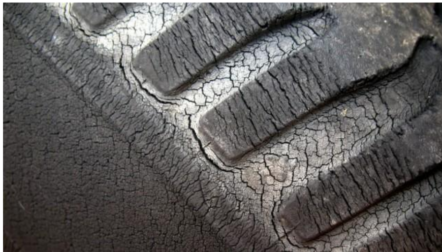
Obr. 6 Tvorba trhlinek na povrchu výrobku vlivem ozonu [17]
