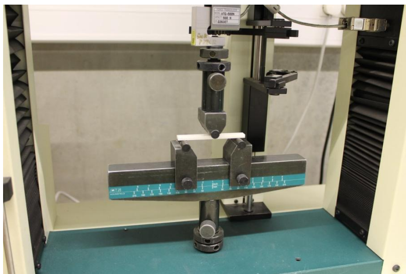
Obr. 16 Měření ohybových vlastností na zkušebním zařízení Hounsfield H10KT [33]
