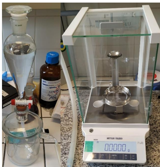
Obr. 14: fotografia aparatury pre meranie porozity keramických nosičov Archimedovou metódou
