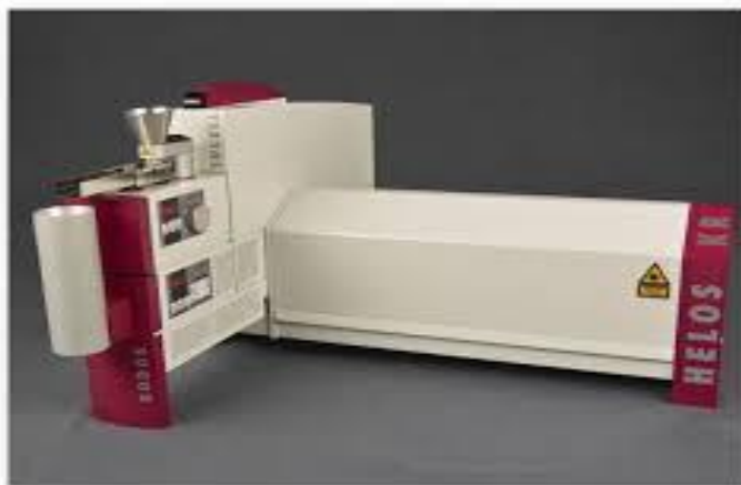
Obr. 12: laserový analyzátor veľkosti častíc HELOS (H2568)&RODOS
