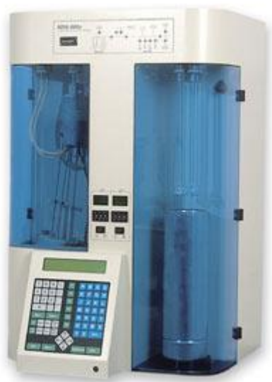
Obr. 11: NOVA 2200 od Quantachrome instruments na určenie špecifického merného povrchu látok[62]
