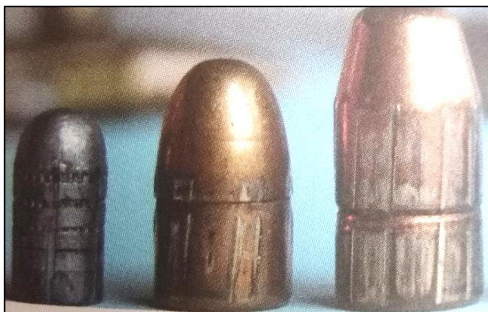
Obrázek č. 3.11 – detail stop na povrchu střel [14]
