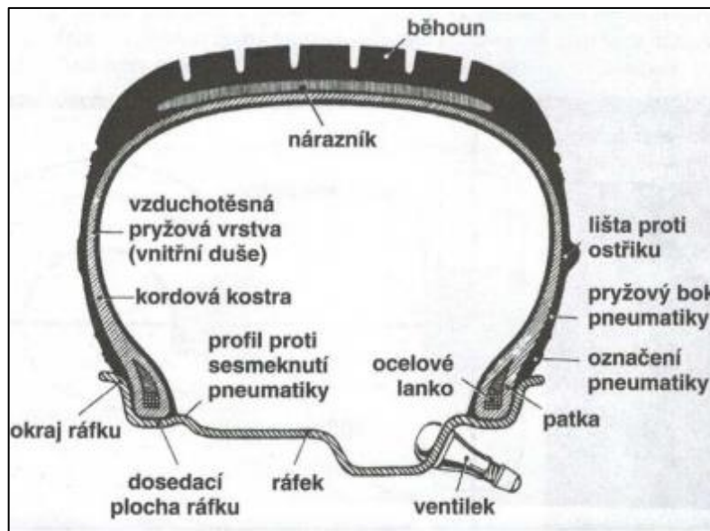
Obrázek č. 3.8 – základní konstrukční prvky pneumatiky [11]
