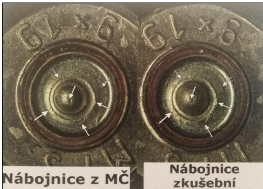
Obrázek č. 3.16 – ukázka komparace dvou nábojnic pod komparačním makroskopem [19]
